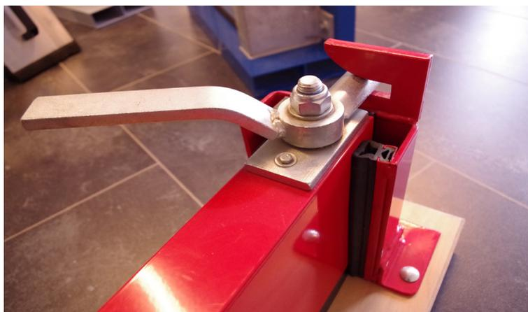
Traverse mise en place entre les rails verticaux. Verrouillage grâce à la rotation des poignées de compression dans leur logement pour assurer l'étanchéité de la barrière.
