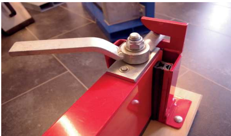
Profilé aluminium mis en place entre les rails verticaux. Verrouillage grâce à la rotation des poignées de compression dans leur logement pour assurer l'étanchéité de la barrière.
